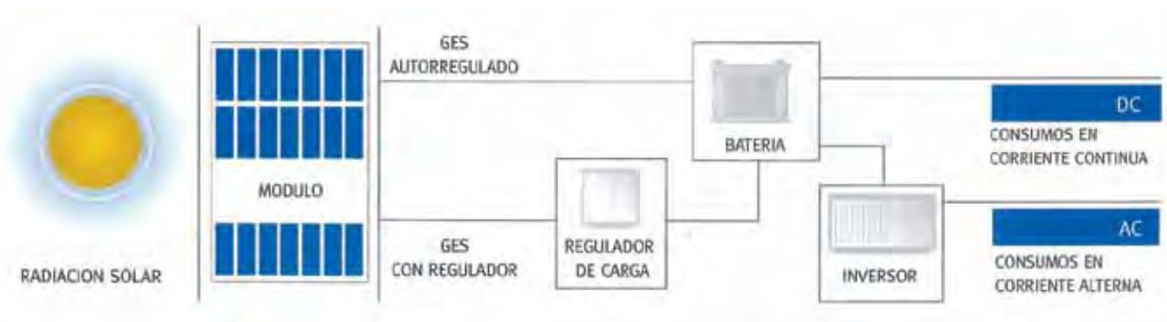
Configuración de los Generadores Eléctricos Solares (GES)
